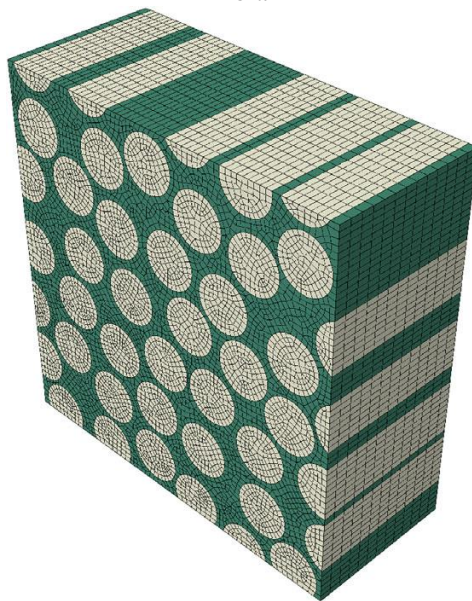
Figura 27 Modelo micromecânico de elementos finitos 3D de compósito de matriz polimérica reforçada com fibra
