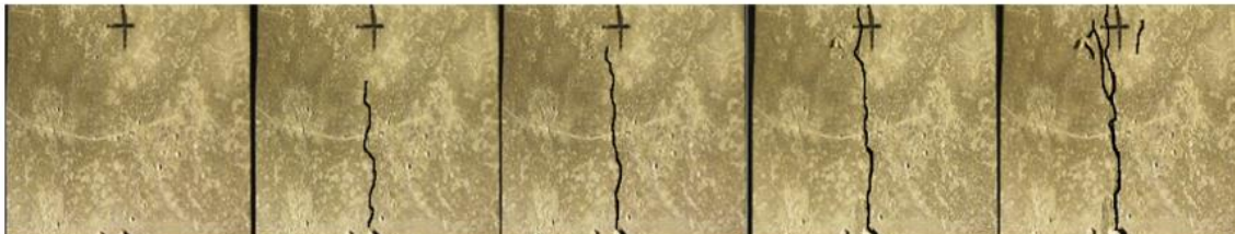
Figura 60 Visualização sequencial da evolução da trinca para CMOD=0.5, 0.5, 1.00, 2.00 e 3.00 mm
