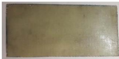
Figura 54 Amostra de compósito laminado cross-ply [0_4/90_4] simétrico
